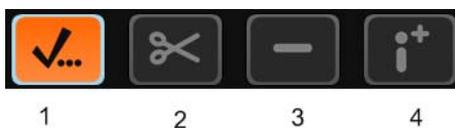
1. **Указать** - Используя эту кнопку, оператор может указать причину выделенного перерыва в работе. Появляется список с возможными типами перерывов в работе и оператор должен выбрать один из них. Нажми *Enter* - Выбери перерыв используя стрелку - нажми *Enter* для подтверждения.
