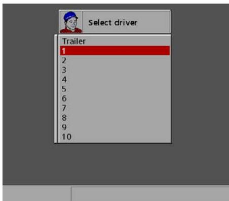
После запуска двигателя и системы MaxiForwarder, необходимо выбрать оператора. На совершенно новой машине нет выбора из предварительно установленных операторов. Всё же существует базовая установка (заводская) для оператора, сохранённая в системе. Если на машине ранее уже работали другие операторы, то в системе могут оказаться введённые ими установки. В этом случае есть возможность выбора (до десяти операторов).
