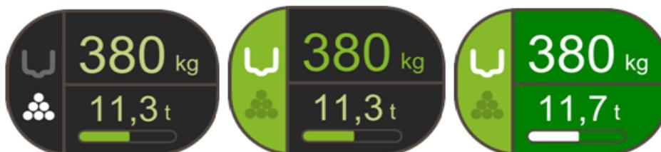
При загрузке, колонка увеличивается слева направо. При разгрузке, колонка понижается обратно к нулевому положению.
